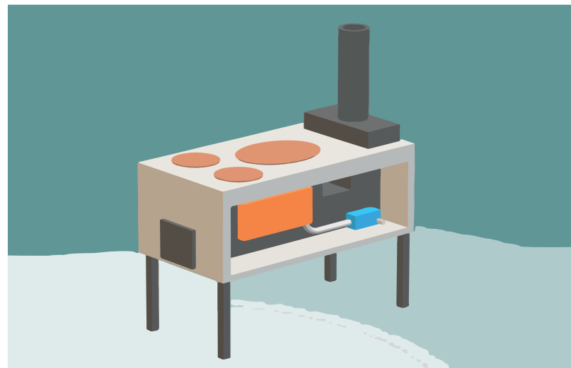
Imagen 2. Modelo 3D de la estufa ecológica. Vista al interior donde se aprecia la integración del panel de antenas y control carga y almacenamiento de energía
