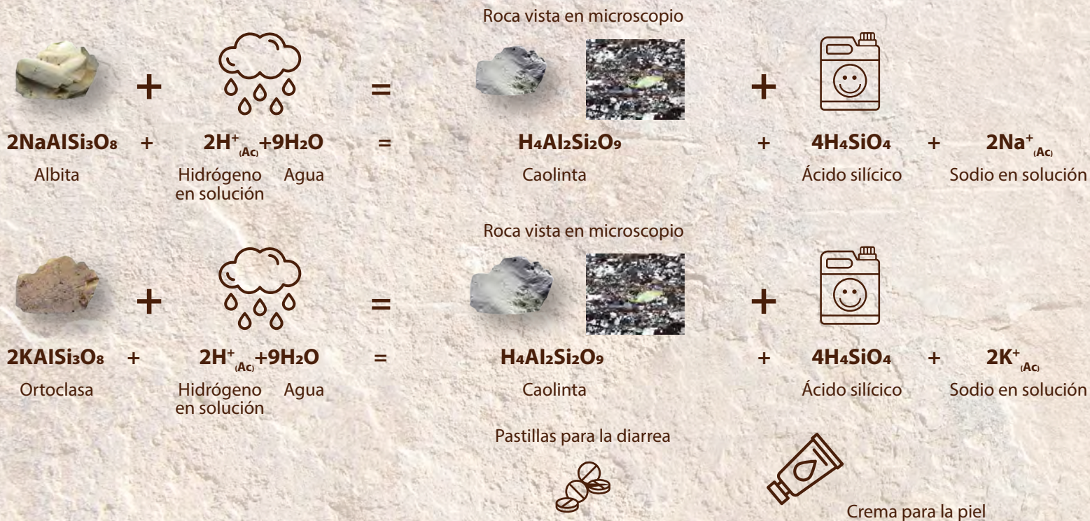
Figura 4. Ejemplos, reacciones químicas y productos que ocurren durante la hidrólisis
